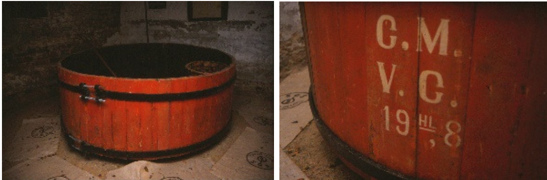
De prachtig gerestaureerde roerkuip van de brouwerij Cipers (eigendom Rik Cipers) C.M. = Cuve Matière; V.C. = Vaisseau Collecteur
